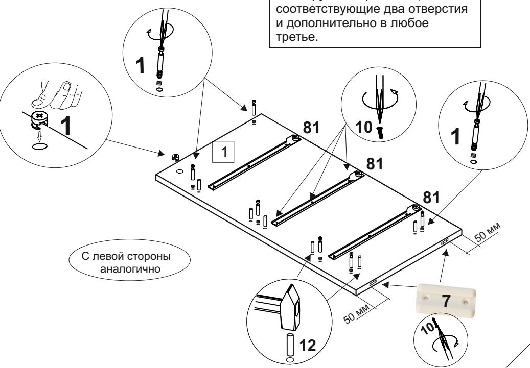
**Внимание:** на боковинах под направляющие нанесены дублирующие задние отверстия, которые соответствуют разным типам направляющих. Фиксируем направляющие в соответствующие два отверстия и дополнительно в любое третье.
