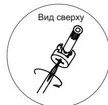
Схема соединения болта с эксцентриком :
